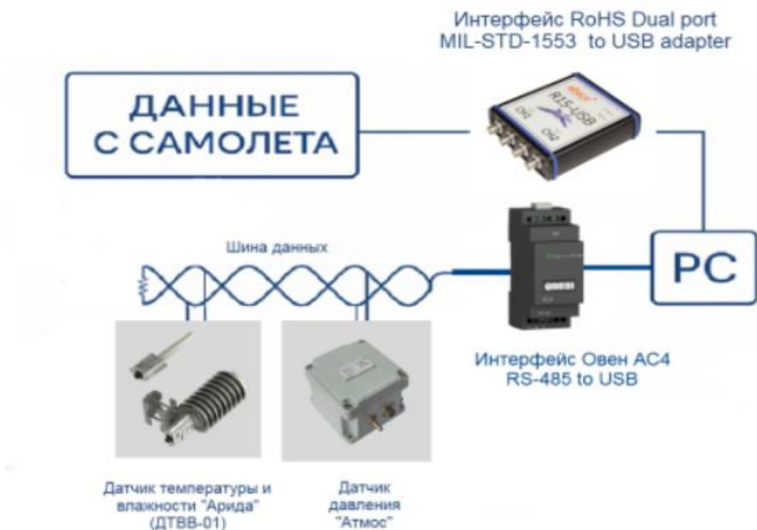
Рис.1. Схема подключения датчиков к компьютеру
